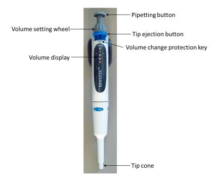
Figure 3. Variable-volume micropipette.
